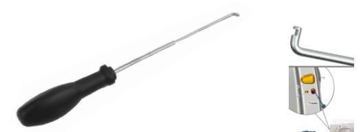
130709 VW.AUDI 凸轮轴链条固定器
